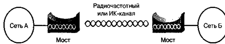
Рис. 6.1. Мосты служат для соединения двух сетей
