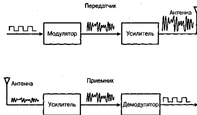
Рис. 3.1. В беспроводной сети сигналы подвергаются процессам усиления и модуляции
