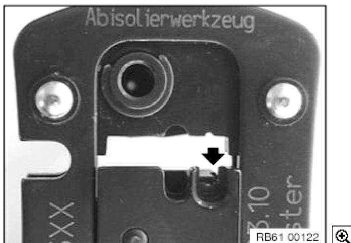
Для снятия изоляции с диэлектрика использовать показанный вырез
